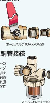
リング珠と押えナットの中に銅管を通し、リング珠を押えナットで締付けることにより銅管を接続する方法です。銅管を加工せずに接続できるので大変便利です。
